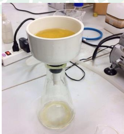
ภาพที่ 19 กรองสุญญากาศอีกครั้ง
