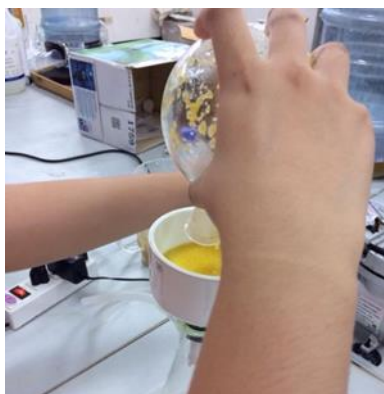
ภาพที่ 17 กรองสุญญากาศโดยใช้กระดาษกรอง เพื่อแยกสารสกัดกับผงเปลือกส้ม
