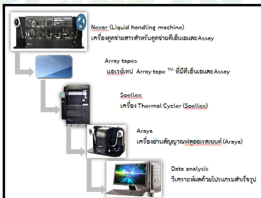
ภาพที่ 11 ขั้นตอนการเตรียมปฏิกิริยา PCR และการตรวจสอบ PCR โดยระบบ Ultra High Throughput Technology of SNPs (Douglas Scientific)
