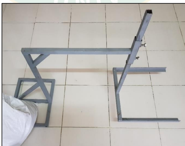
ภาพที่ 59 โครงเสาตั้งแผงเซลล์แสงอาทิตย์
