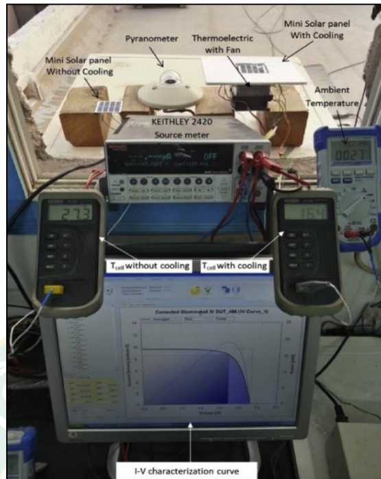
ภาพที่ 19 อุปกรณ์การทดลองเปรียบเทียบแผงเซลล์แสงอาทิตย์ที่มี และไม่มีการระบายความร้อน
