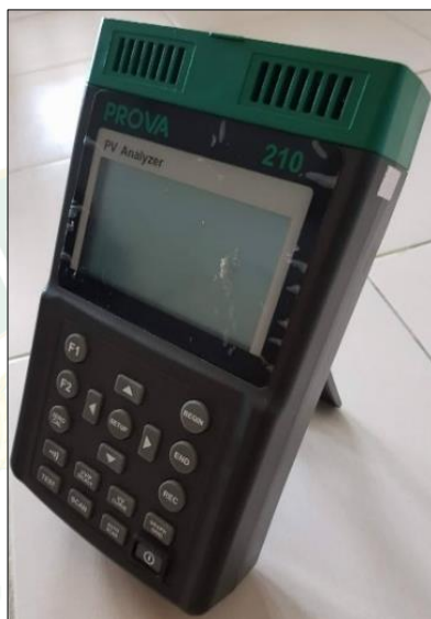
ภาพที่ 54 เครื่องตรวจวัดกำลังไฟฟ้าแผงเซลล์แสงอาทิตย์
