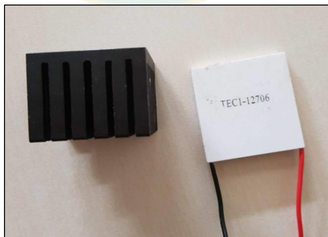
ภาพที่ 51 แผ่นเทอร์โมอิเล็กทริก และแผงระบายความร้อนอลูมิเนียมที่ใช้ทดสอบ
