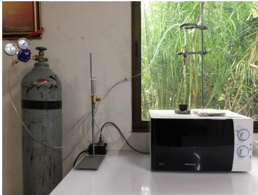
ภาพที่ 25 ชุดผลิตเชื้อเพลิงทอรรีไฟต์ด้วยคลื่นไมโครเวฟ
