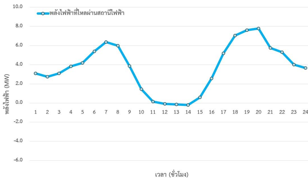
ภาพผนวกที่ 6 ลักษณะพลังไฟฟ้าที่ไหลผ่านสถานีไฟฟ้า กรณีโรงไฟฟ้าพลังงานแสงอาทิตย์ มีกำลังผลิตลดลง 40% จากกรณีฐาน
