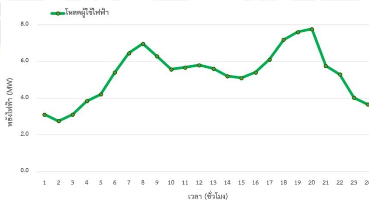
ภาพที่ 12 ลักษณะโหลดผู้ใช้ไฟฟ้าเฉลี่ยของระบบจำหน่ายไฟฟ้า สถานีไฟฟ้าเดิมบางนางบวช รหัสวงจร DBA04 ช่วงวันที่ 18 - 24 กุมภาพันธ์ 2562
