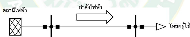
ภาพที่ 4 รูปแบบการไหลของกำลังไฟฟ้ากรณีไม่มี VSPP
