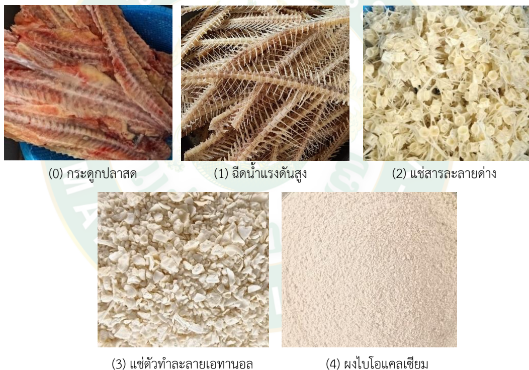
ภาพที่ 9 กระดูกปลาลูกผสมบิกสยามเมื่อผ่านกระบวนการผลิตต่าง ๆ จนได้เป็นผงไปโอแคลเซียม
