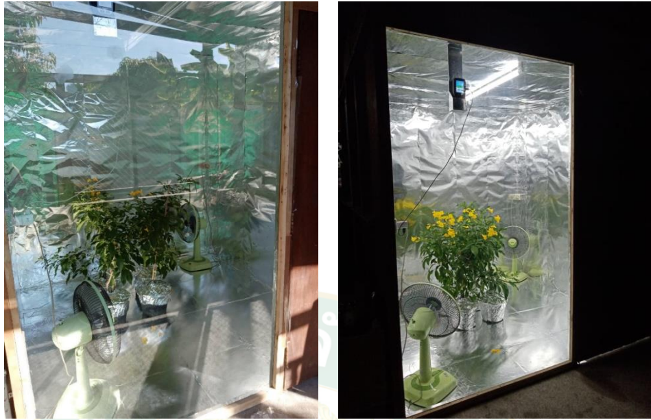
ภาพที่ 16 ตัวอย่างการทดลองประสิทธิภาพการดักจับฝุ่นละออง PM 2.5 ของพันธุ์ไม้พุ่ม
