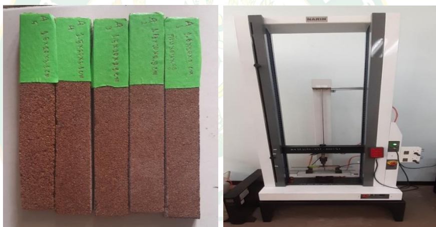
ภาพที่ 27 ชิ้นงานที่ทดสอบ และเครื่องทดสอบอเนกประสงค์ Universal Testing Machine, Model NRI-TI-500 10B (Extra)
