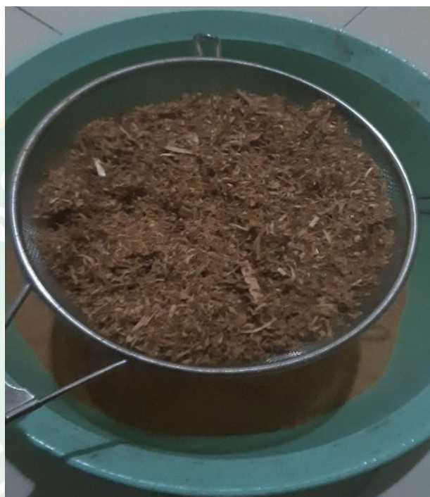
ภาพที่ 17 การร่อนขี้เลื่อยไม้สักเพื่อแยกขนาดด้วยตะแกรงเบอร์ 10
