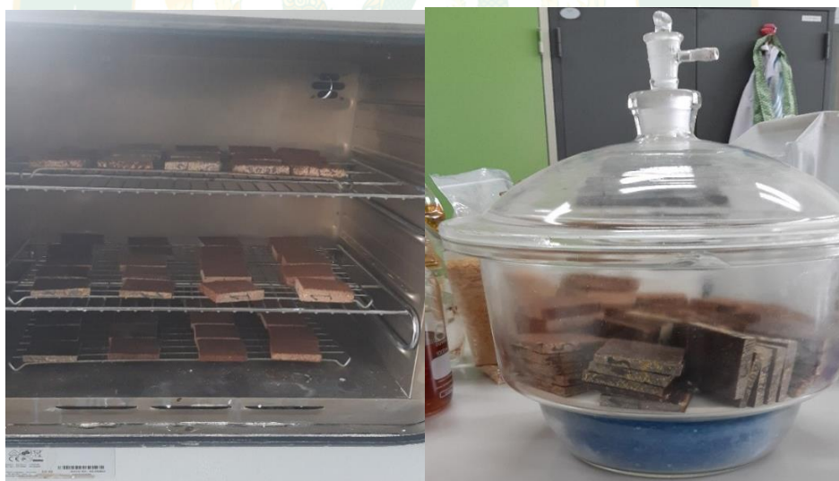
ภาพที่ 23 นำชิ้นทดสอบไปอบในเตาอบ และใส่ในโถดูดความชื้น
