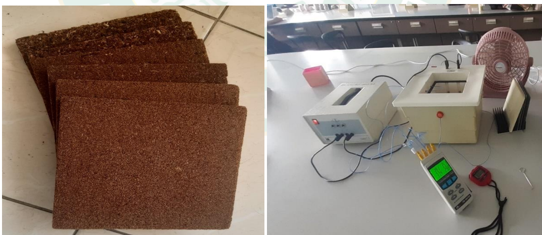
ภาพที่ 25 แผ่นพาร์ติเกิล และเครื่องที่ใช้ในการทดสอบการนำความร้อนด้วยวิธี single plate
