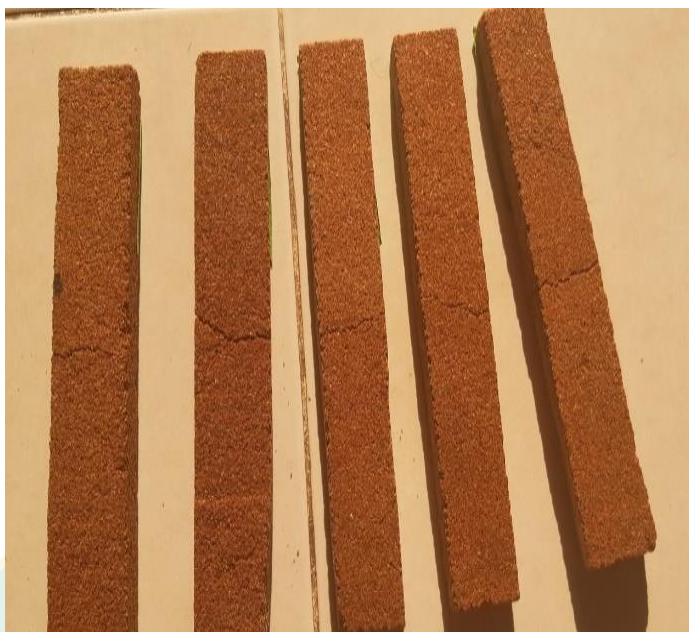
การแตกหักของชิ้นงานภายหลังทดสอบค่าความต้านทานแรงดัด และค่ามอดุลัสยืดหยุ่น
