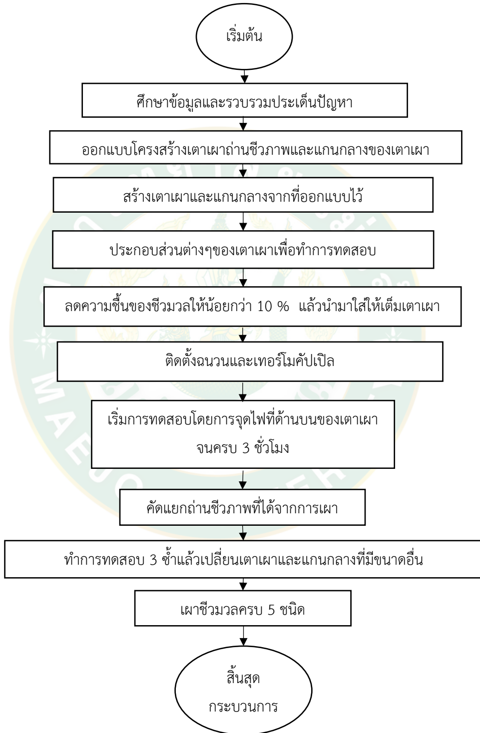
ภาพที่ 4 ขั้นตอนการดำเนินงานการทดสอบจริง
