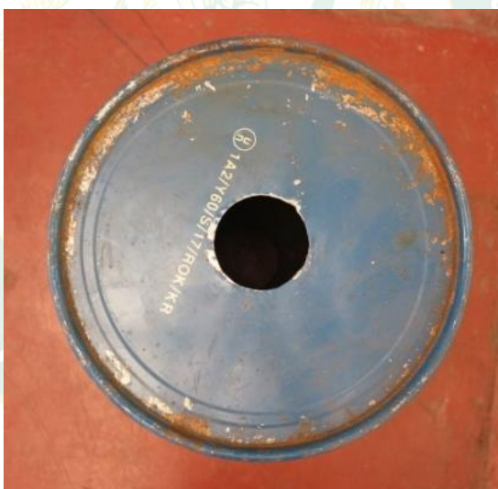
ภาพที่ 7 ฝาถังที่เจาะรูขนาดเส้นผ่าศูนย์กลาง 11 เซนติเมตร
