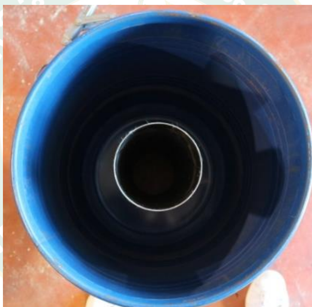
ภาพที่ 9 แกนกลางขนาดเส้นผ่าศูนย์กลาง 11 เซนติเมตรที่เจาะรูแล้ว
