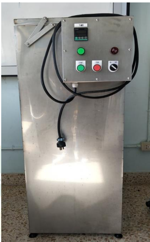
ภาพที่ 37 เครื่องกรองระบบสุญญากาศ
