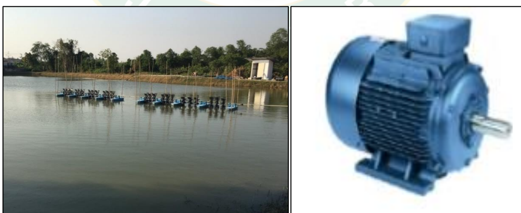
รูปที่ 19 เครื่องเติมอากาศและมอเตอร์แบบใบพัดตีน้ำ
