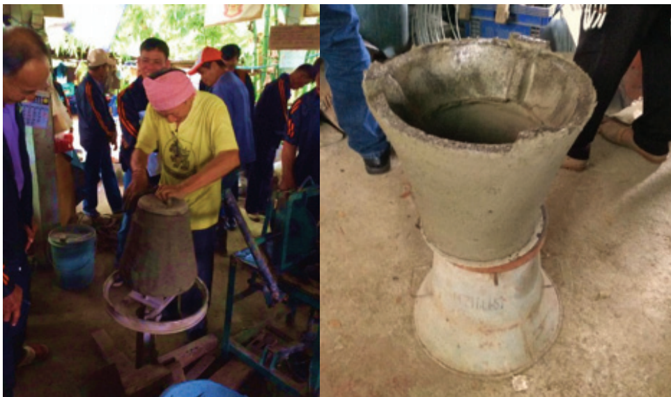
ภาพที่ 4 ขั้นตอนการขึ้นรูปเตา
