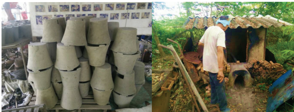
ภาพที่ 6 เตาอุโมงค์ สำหรับเผาชิ้นงาน
