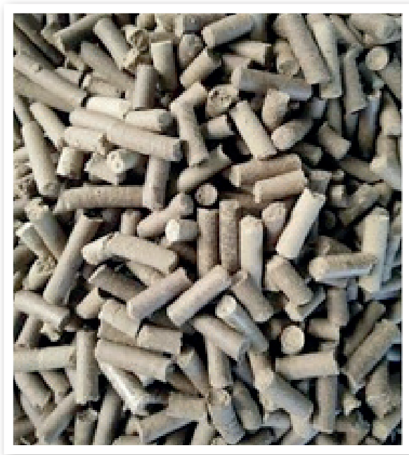
ภาพที่ 7 ชีวมวลอัดเม็ดจากเปลือกหุ้มเมล็ดกาแฟ
