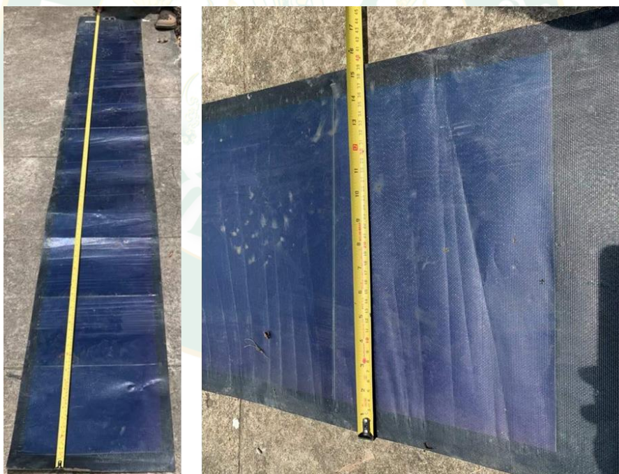
ภาพที่ 22 เซลล์แสงอาทิตย์ชนิดฟิล์มบางที่แยกออกจากกระจกแล้ว
