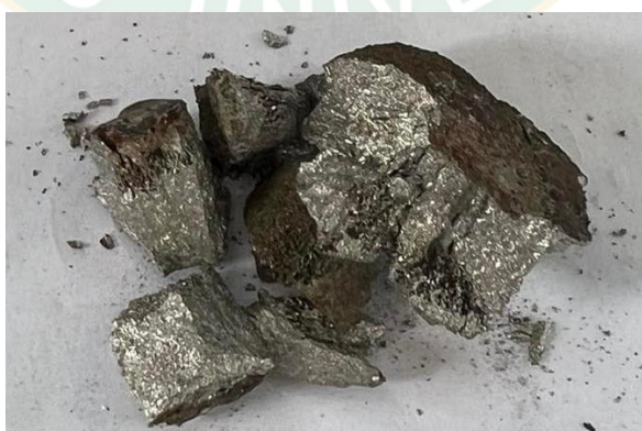
ภาพที่ 35 การเสียหายของวัสดุ ณ จุดประลัย
