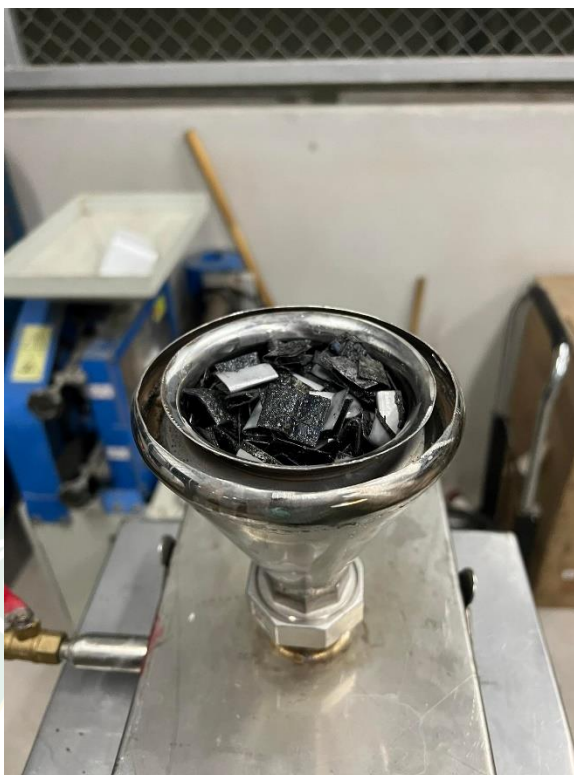
ภาพที่ 25 การบรรจุตัวอย่างขยะจากแผงเซลล์แสงอาทิตย์ชนิดฟิล์มบางในอุปกรณ์ป้อนวัตถุดิบ
