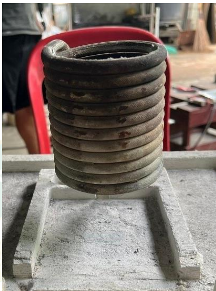
ภาพที่ 18 ขดลวดเหนี่ยวนำที่ออกแบบและสร้างเพื่อใช้ในงานวิจัยนี้
