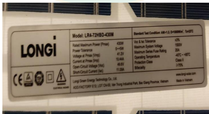
ภาพที่ 22 แผง Bifacial PV สำหรับใช้ในการทดสอบ
