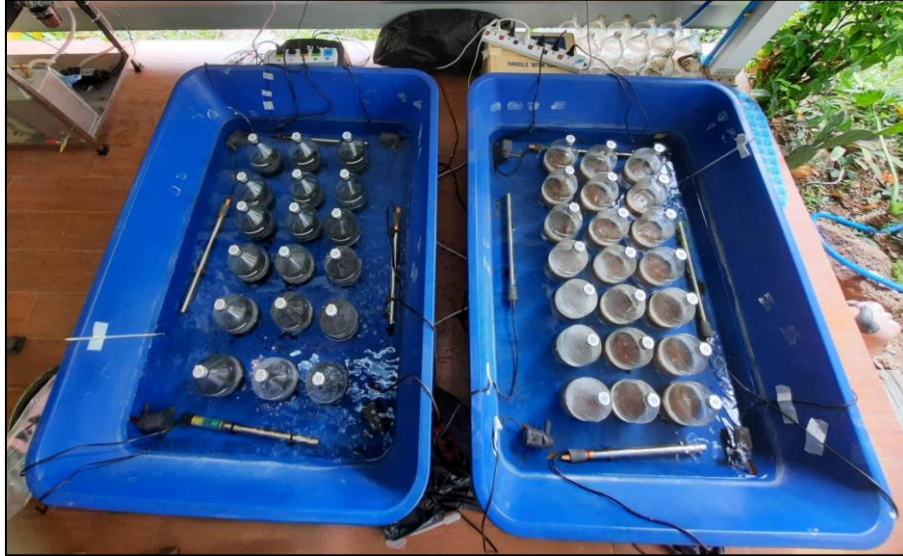
ภาพที่ 11 ระบบผลิตก๊าซชีวภาพขนาด 1,000 mL
