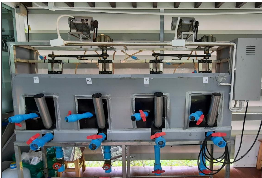
ภาพที่ 14 ระบบผลิตก๊าซชีวภาพขนาด 30 L
