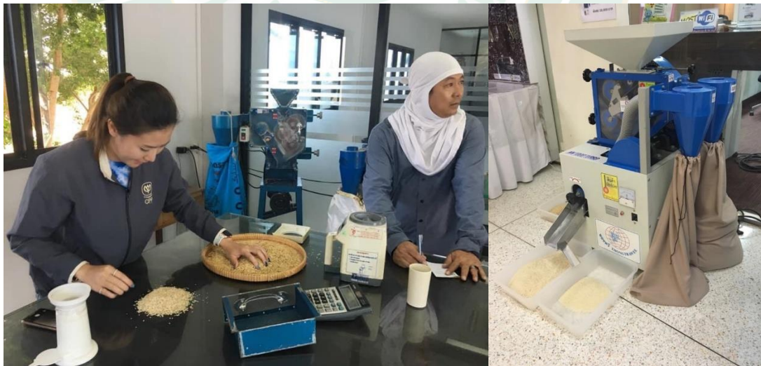
ภาพภาคผนวก 7 ส่งตัวอย่างเข้าแลปและกระเทาะเปลือกเป็นข้าวสาร
