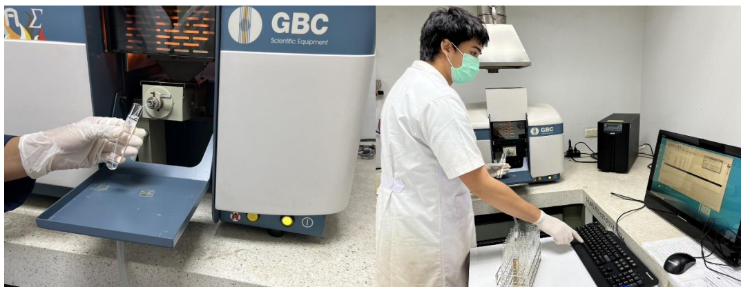
ภาพภาคผนวก 10 การวิเคราะห์หาเหล็กและสังกะสี ด้วยเครื่อง Atomic Absorption Spectrophotometer (AAS)
