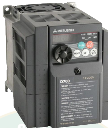
ภาพที่ ก.16 อินเวอร์เตอร์ปรับความเร็วรอบมอเตอร์ (ยี่ห้อ Mitsubishi รุ่น D700)
