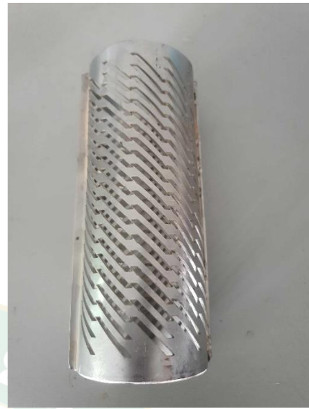
ภาพที่ ก.5 ตะแกรงรูสี่เหลี่ยมขนาด 3.0 mm
