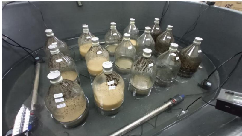
ภาพผนวกที่ 9 ลักษณะการวางตำแหน่งปั้มน้ำ อุปกรณ์ให้ความร้อน และอุปกรณ์วัดอุณหภูมิ
