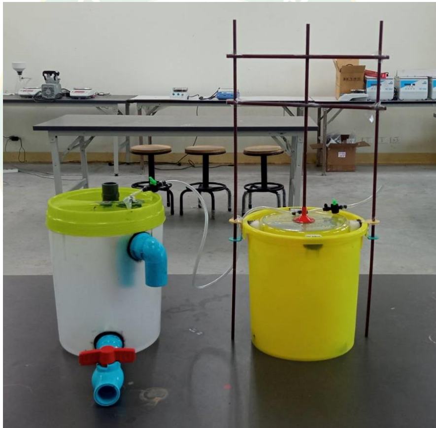
ภาพผนวกที่ 12 ลักษณะถังหมักและถังเก็บก๊าซชีวภาพของการทดลองแบบกึ่งต่อเนื่อง
