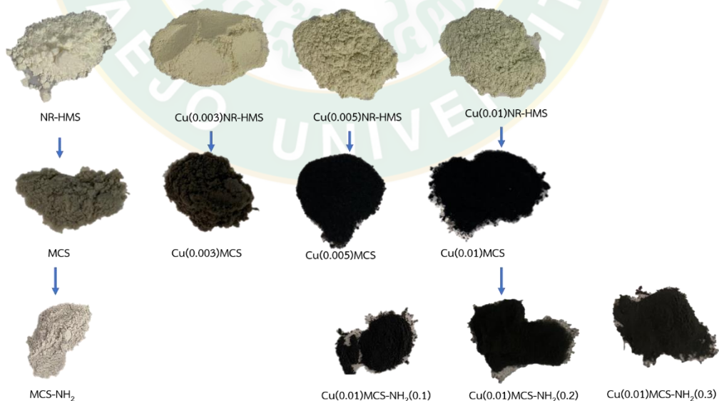
รูปที่ 24 วัสดุ NR/HMS, Cu/NR/HMS และวัสดุดูดซับ Cu/MCS ที่ความเข้มข้นแตกต่างกัน วัสดุดูดซับ Cu/MCS-NH 2 ที่ความเข้มข้นแตกต่างกัน
