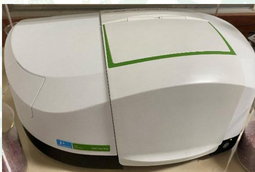
รูปที่ 17 เครื่อง Fourier transform infrared spectroscopes ยี่ห้อ PerkinElmer รุ่น Spectrum One
