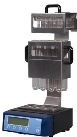
รูปที่ 22 เครื่อง FOSS DT 208 Digestor และ เครื่องกลั่นตัวอย่าง FOSS Kjeltec 8200 ดังรูปที่ 23
