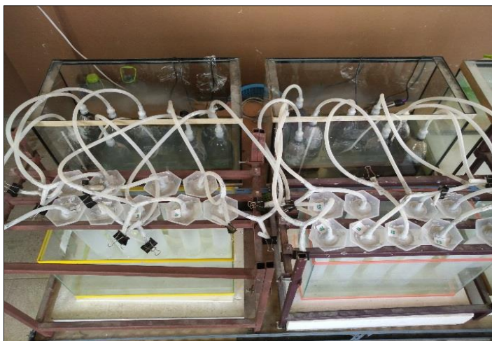
ภาพที่ 13 แสดงชุดทดลองระบบผลิตชีวภาพขนาด 1 L
