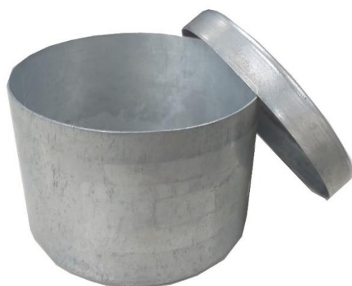
ภาพที่ ก.10 ครอบอะลูมิเนียม (Moisture can)
