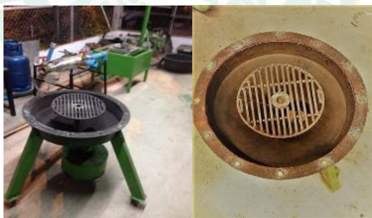
ภาพที่ 34 การปรับปรุงชุดห้องรองซีเถ้าเตาผลิตแก๊สชีววมวลแบบไหลลง
