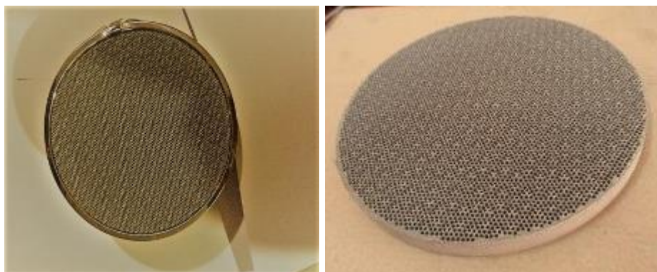
ภาพที่ 38 หัวเตาแก๊สชีวมวลประสิทธิภาพสูง
