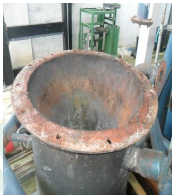
ภาพที่ 30 ห้องเผาไหม้เตาผลิตแก๊สชีวมวลแบบไหลลงใช้วัสดุเหล็กเหนียว
