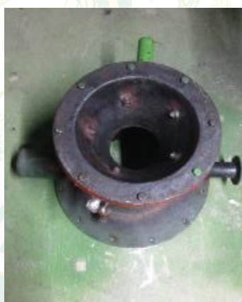
ภาพที่ 31 ห้องเผาไหม้เตาผลิตแก๊สชีวมวลแบบไหลลงใช้วัสดุเหล็กหล่อ
