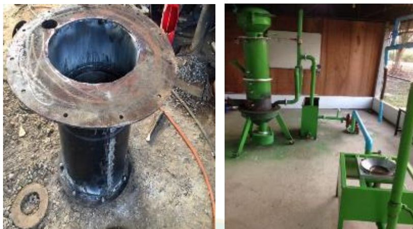
ภาพที่ 33 การปรับปรุงชุดปลอกเสื่อห้องเผาไหม้เตาผลิตแก๊สชีววมวลแบบไหลลง
