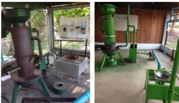
ภาพที่ 32 การปรับปรุงชุดป้อนเชื้อเพลิงเตาผลิตแก๊สชีวมวลแบบไหลลง
