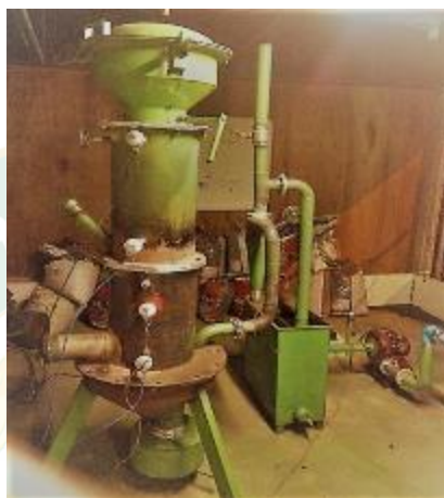
ภาพที่ 35 การติดตั้งชุดเครื่องมือวัดตามจุดเตาผลิตแก๊สชีวมวลแบบไหลลง
