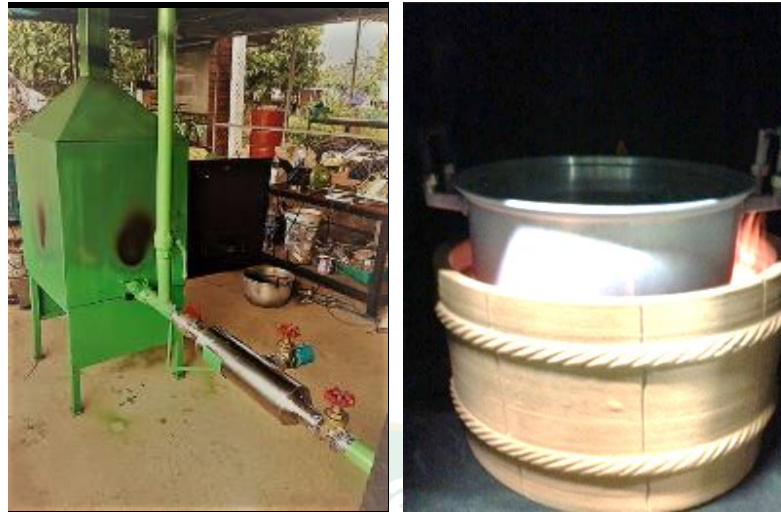
ภาพที่ 29 การทดสอบหัวเตาแก๊สชีวมวลประสิทธิภาพสูง
