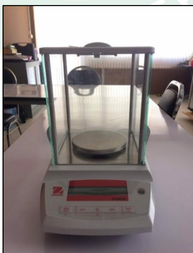
ภาพที่ 39 เครื่องชั่งดิจิทัลทศนิยม 4 ตำแหน่ง
