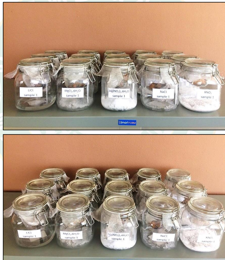
ภาพที่ 17 ตัวอย่างปลาตุ๋กภายในขวดแก้วปิดสนิทซึ่งบรรจุสารละลายเกลืออิมตัว 5 ชนิด
