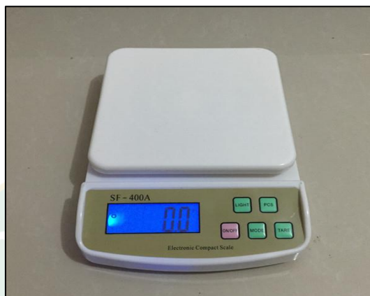
ภาพที่ 38 เครื่องชั่งน้ำหนักพกพาแบบดิจิทัลพิกัดกำลัง 10 kg ค่าละเอียด 0.1 g
