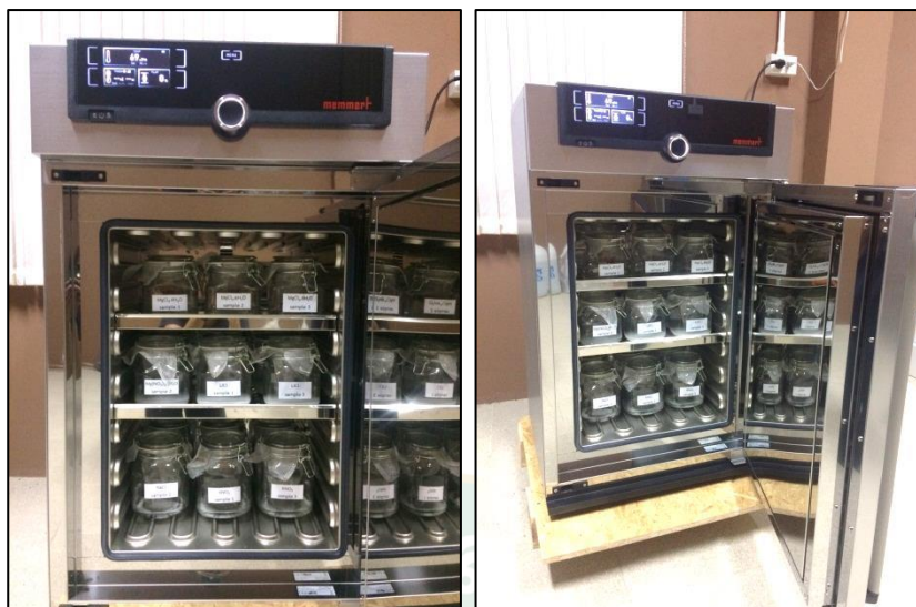
ภาพที่ 18 การควบคุมอุณหภูมิอากาศแวดล้อมโดยการนำขวดแก้วเข้าสู่ตู้อบลมร้อน
