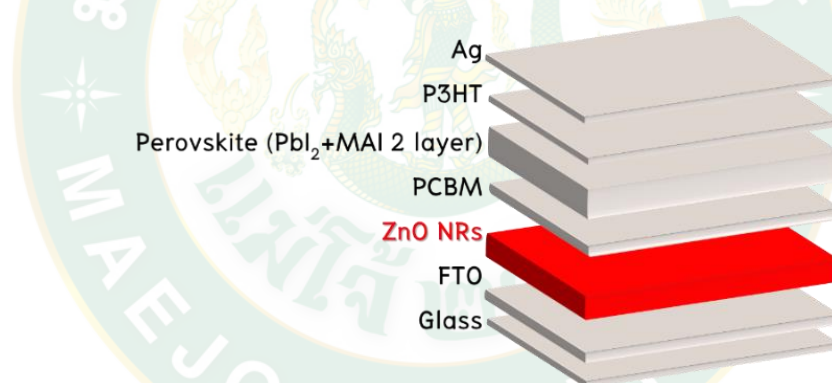
ภาพที่ 43 โครงสร้างที่ใช้โดยมีแท่งนาโนซิงก์ออกไซด์เป็นชั้นนำอิเล็กทรอนิกส์
