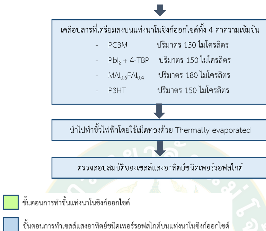
ภาพที่ 44 แผนผังแสดงขั้นตอนการเตรียมฟิล์มบางซิงก์ออกไซด์จากกระบวนการอุณหภูมิ ต่ำสำหรับชั้นนำอิเล็กตรอนในเซลล์แสงอาทิตย์ชนิดเพอร์รอฟสไกต์
