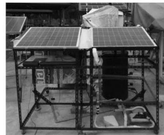
รูปที่ 3 โมดูลเซลล์แสงอาทิตย์อ้างอิง(PV1) (ซ้าย) โมดูลเซลล์แสงอาทิตย์ที่ติดตั้งส่วนระบายความร้อน(PV2) (ขวา)
