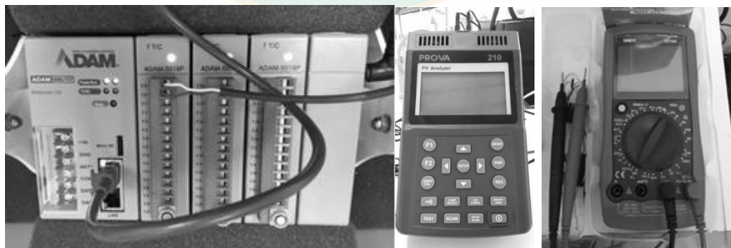
ภาพที่ 37 Data logger รุ่น ADAM 5000L/TCP (ซ้าย) PV Analyzer รุ่น PROVA 210 (กลาง) มัลติมิเตอร์ UNI-T รุ่น UT106 (ขวา)
