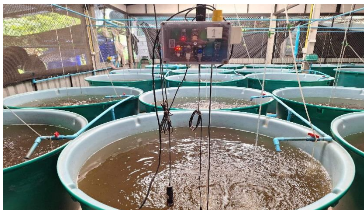
ภาพผนวกที่ 3 ชุดอุปกรณ์ตรวจวัดคุณภาพน้ำในบ่อเลี้ยง
