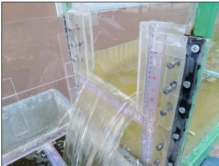
ภาพภาคผนวกที่ 12 การทดสอบฝายรูปแบบสี่เหลี่ยมผืนผ้า ที่ความหนา 25 mm
