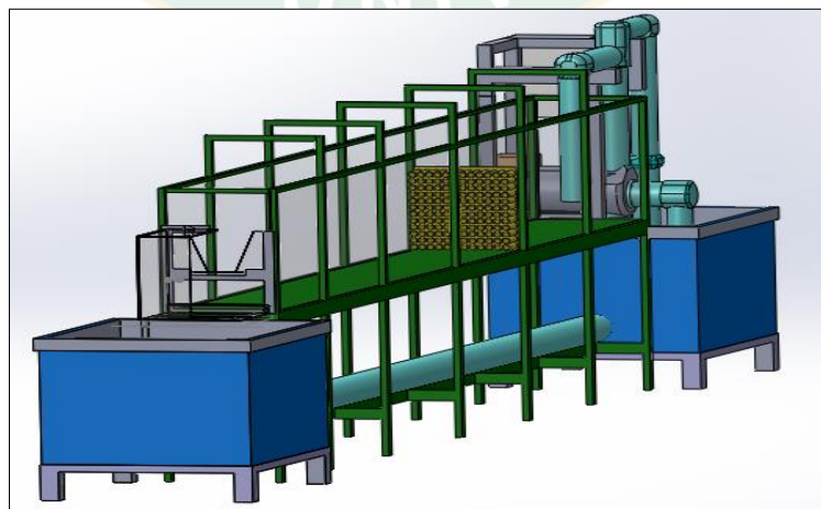
ภาพที่ 25 อุโมงค์น้ำแบบเปิด (Open Flow Water Tunnel)
