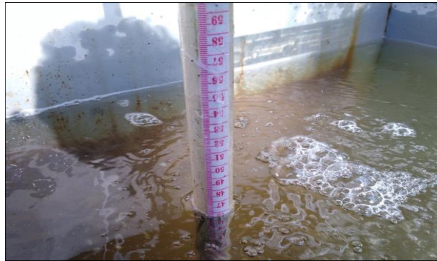
ภาพที่ 30 แสดงสเกลวัดระดับน้ำในถัง ( h_T )
