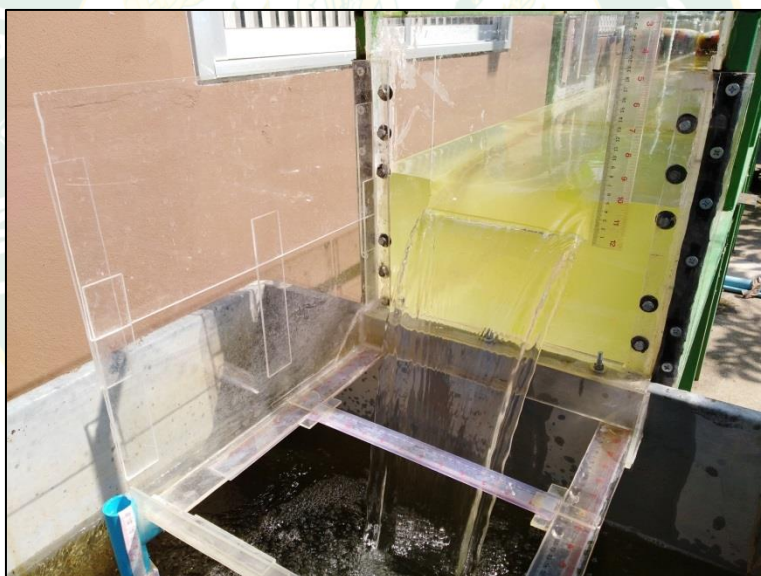
ภาพภาคผนวกที่ 13 การทดสอบฝายรูปแบบสี่เหลี่ยมผืนผ้า ที่ความหนา 3 mm
