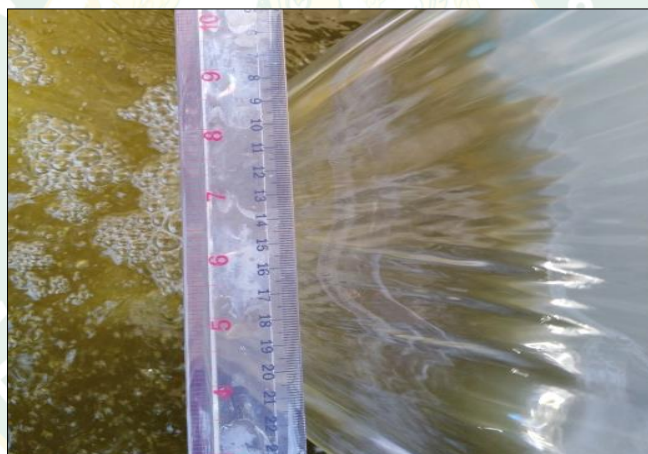
ภาพที่ 34 แสดงสเกลวัดความกว้างของน้ำล้นที่ระยะจุดตก (N)
