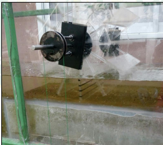
ภาพที่ ง-16 การทดลองกังหันน้ำแบบหลุกด้าที่ระดับการจมน้ำ 110% ของความสูงใบพาย
