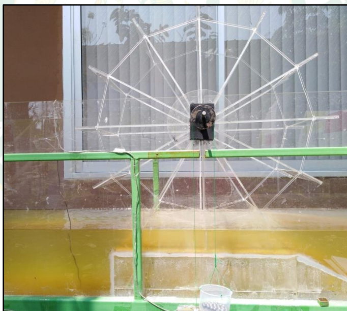
ภาพที่ ง-10 การทดลองกักน้ำแบบหลุกต่ำที่รัศมีกักน้ำ 125% ของความยาวใบพาย (37.5 cm)
