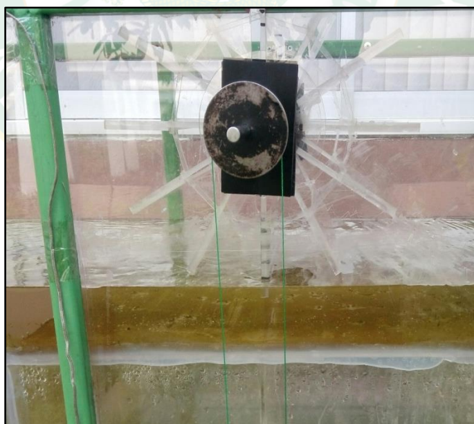
ภาพที่ ง-12 การทดลองกังหันน้ำแบบหลุกต๋ำที่ระดับการจมน้ำ 25% ของความสูงใบพาย
