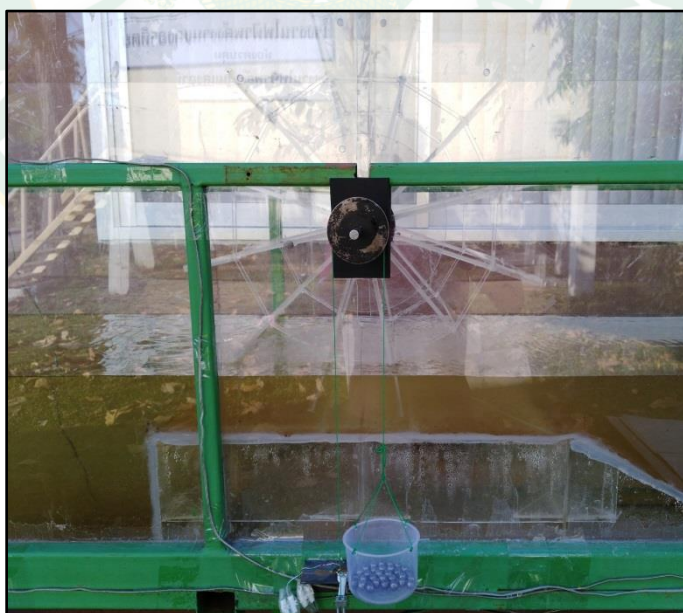
ภาพที่ ง-8 การทดลองกังหันน้ำแบบลูกตุ้มที่รัศมีกังหัน 75% ของความยาวใบพาย (22.5 cm)
