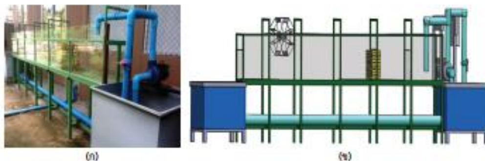
ภาพที่ 3 (ก) อุโมงค์น้ำแบบเปิด (ข) การติดตั้งกังหันน้ำแบบหลุกต่ำในอุโมงค์น้ำแบบเปิด
