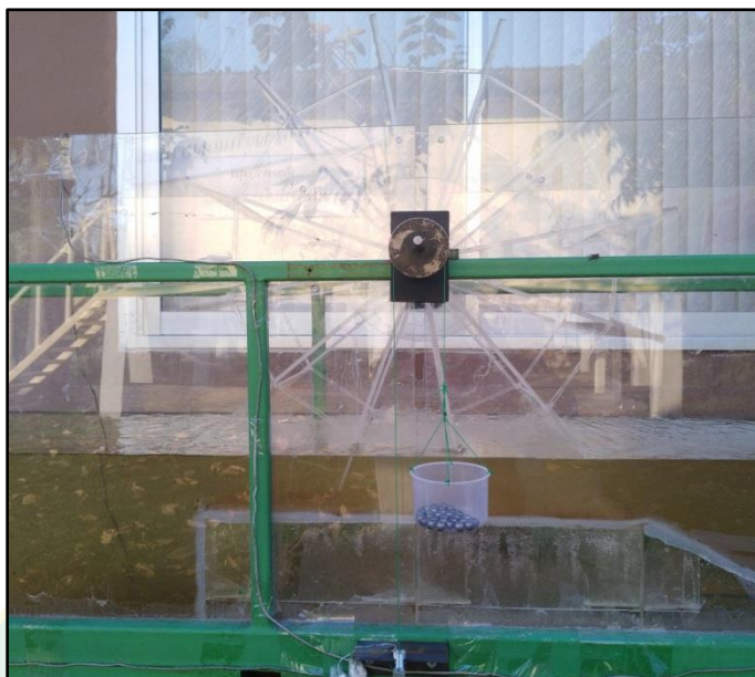
ภาพที่ ง-9 การทดลองกักน้ำแบบหลุกต่ำที่รัศมีกักน้ำ 100% ของความยาวใบพาย (30 cm)
