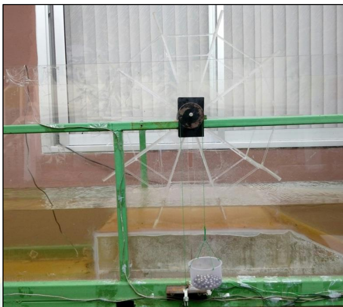
ภาพที่ ง-3 การทดลองกักน้ำแบบหลุกดำที่จำนวนใบพาย 10 ใบ
