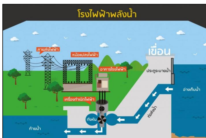
ภาพที่ 2.2 ลักษณะการทำงานของพลังงานน้ำจากเขื่อน
