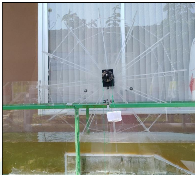
ภาพที่ ง-11 การทดลองกังหันน้ำแบบหลุกต๋ำที่รัศมีกังหัน 150% ของความยาวใบพาย (45 cm)
