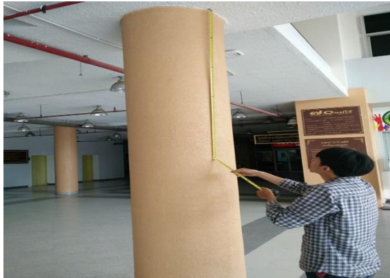
ภาพที่ 55 ตรวจวัดความสูงของชั้น
