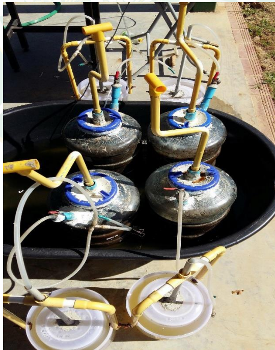
ภาพที่ ข-6 การทดลองผลิตแก๊สชีวภาพในระดับระดับห้องปฏิบัติการ
