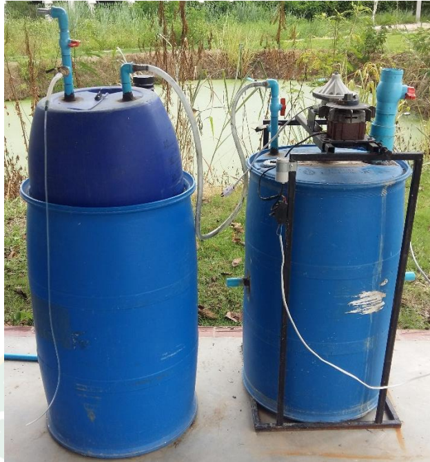
ภาพที่ ค-3 ระบบผลิตแก๊สชีวภาพระบบครัวเรือน
