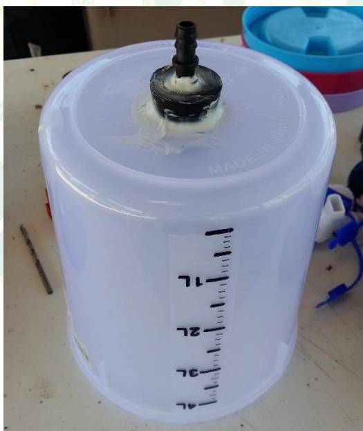
ภาพที่ ข-2 สร้างถังเก็บแก๊สขนาด 5 L สำหรับการทดลองในระดับห้องปฏิบัติการ
