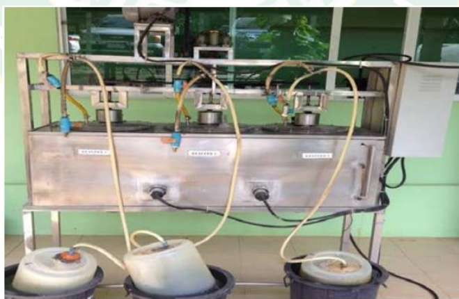
ภาพที่ 9 ชุดทดลองศักยภาพการผลิตแก๊สมีเทนจากการใช้มูลสุกรและหญ้าเนเปียร์หมัก
