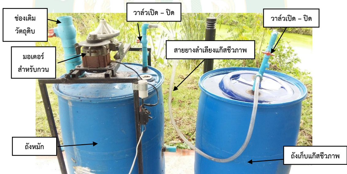
ภาพที่ 23 การทดลองผลิตแก๊สชีวภาพในระดับห้องครัวเรือน
