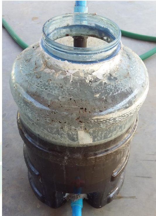
ภาพที่ ข-5 ตั้งทิ้งไว้สำหรับตกตะกอน
