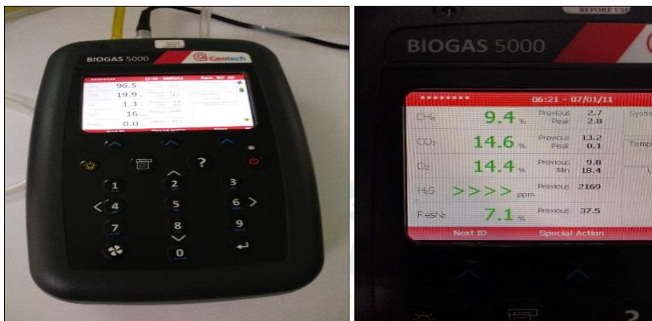
ภาพผนวกที่ 1 เครื่องวัดแก๊ส Geotech biogas 5000
