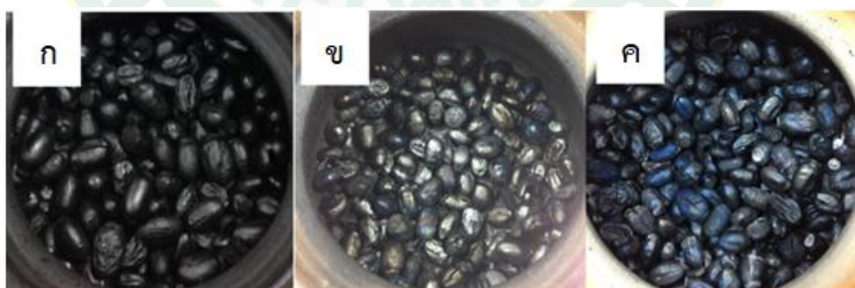
ภาพที่ 39 ถ่านเมล็ดลิ้นจี่ที่อุณหภูมิการเผา (ก) 400, (ข) 500 และ (ค) 600 °C
