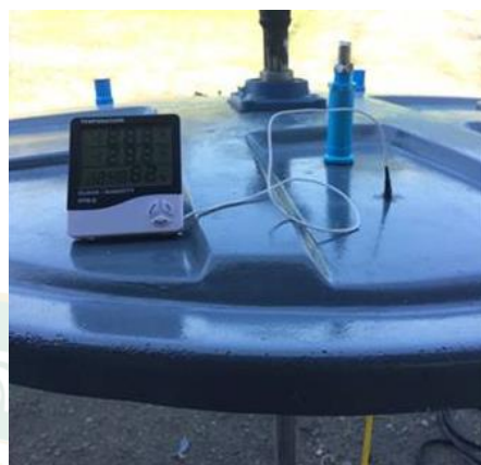
(ก) การเจาะรูบริเวณฝาถังปฏิกรณ์ (ข) ลักษณะของการประกอบที่วัดอุณหภูมิ ภาพภาคผนวกที่ 6 การเจาะรูของถังปฏิกรณ์ (ฝาถังปฏิกรณ์)
