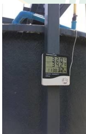
ภาพภาคผนวกที่ 11 การติดตั้งเครื่องวัดอุณหภูมิบริเวณข้างถังปฏิกรณ์
