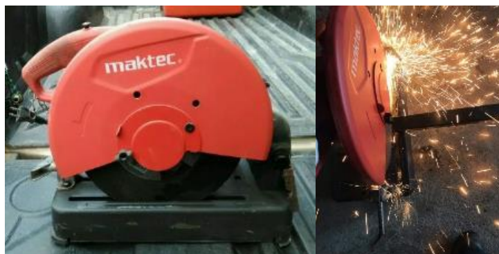
ภาพภาคผนวกที่ 2 การตัดเหล็กด้วยแท่นตัดไฟเบอร์
