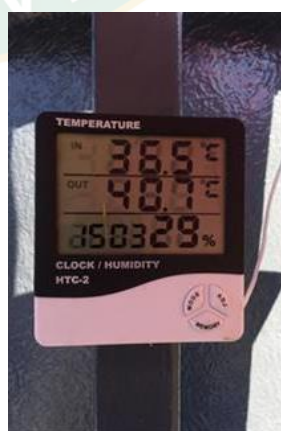
ภาพภาคผนวกที่ 11 การติดตั้งเครื่องวัดอุณหภูมิบริเวณข้างถังปฏิกรณ์
