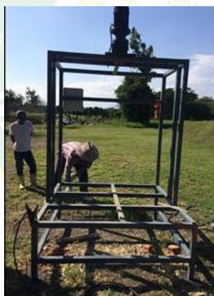
(ก) การเชื่อมมอเตอร์เข้ากับคาน (ข) การติดตั้งชุดมอเตอร์กวนผสมเข้ากับถังปฏิกรณ์
