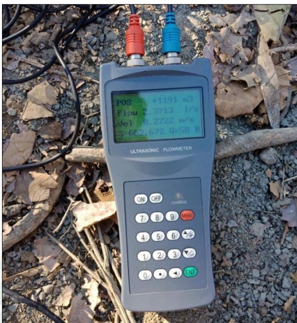
ภาพที่ 28 ผลการตรวจวัดอัตราการไหลของน้ำพุร้อนในส่วนที่ส่งไปยังถังพักน้ำพุร้อน
