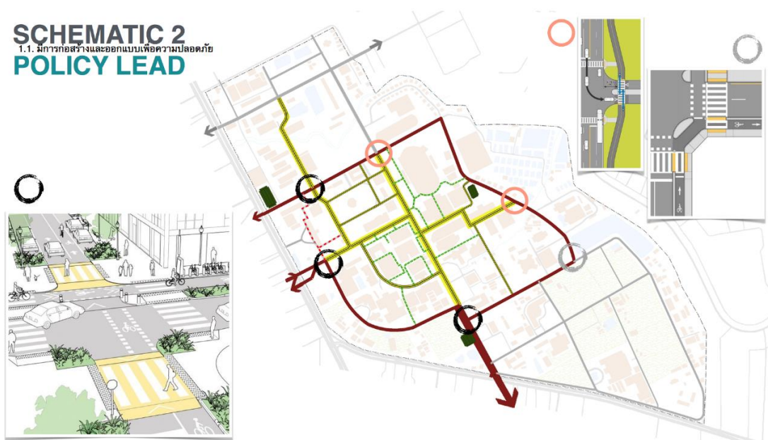
ภาพที่ 35 แสดงจุดชะลอความเร็วของผังทางเลือกที่ 2
