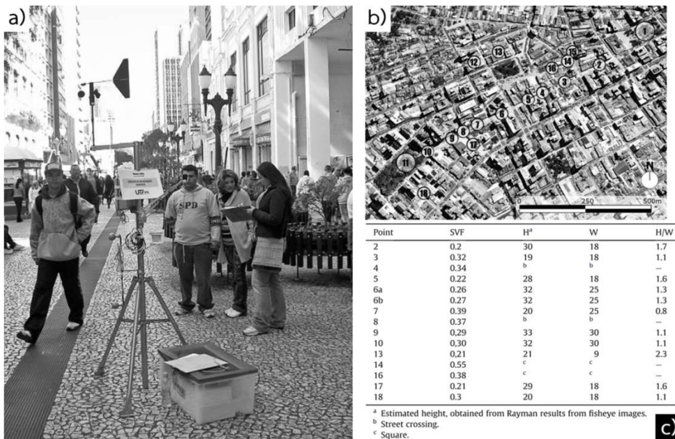
ภาพที่ 68 a) การตรวจวัดทางอุตุนิยมวิทยาภาคสนาม เหนือพื้นดิน 1.6 เมตร b) ตำแหน่งของจุดตรวจวัดทางอุตุนิยมวิทยา c) ตารางแสดงลักษณะทางกายภาพของจุดตรวจวัดภาคสนาม ที่มา : Krüger et al. (2011)
