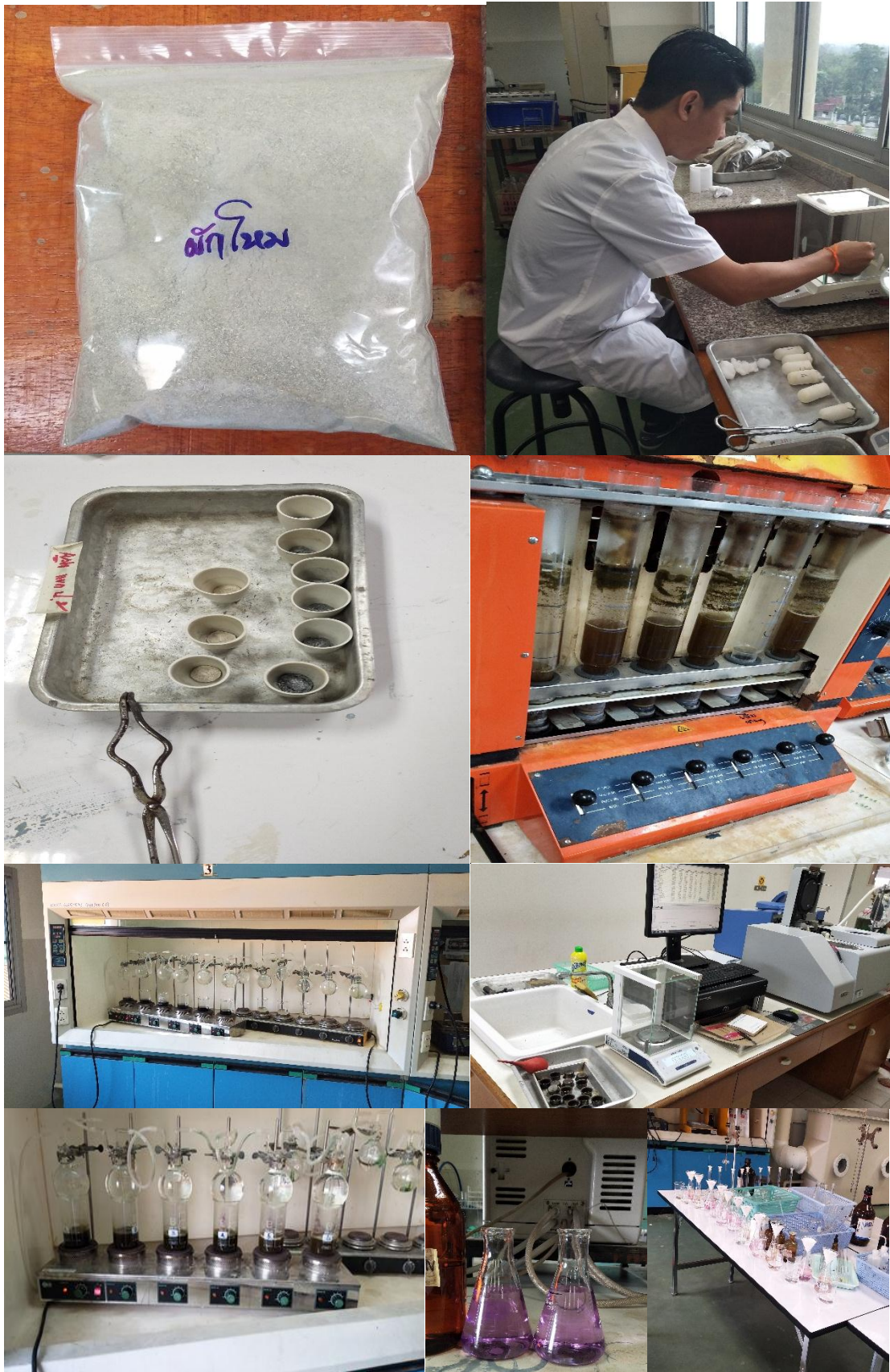
ภาพที่ 16 ภาพประกอบการวิเคราะห์หาองค์ประกอบของโภชนะ
