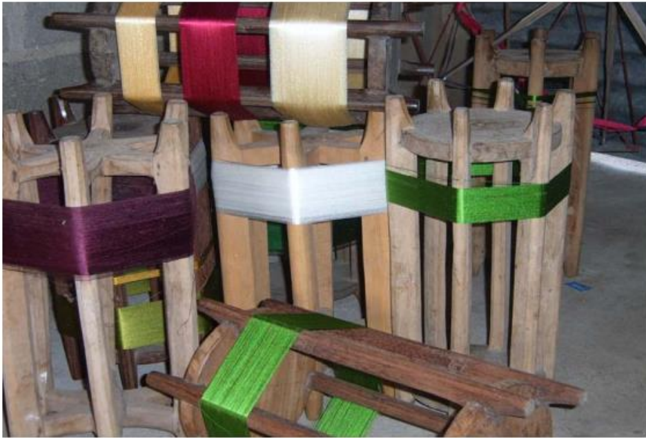
ภาพผนวกที่ 20 อักที่ใช้สำหรับปั่นเส้นไหมหลังจากสาวไหมเส้น เป็นการจัดระเบียบเส้นไหม
