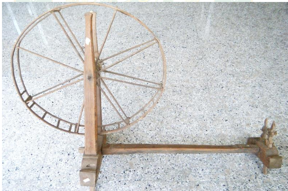
ภาพผนวกที่ 23 ไน หรือรหัทส ใช้สำหรับกรอเส้นไหมเข้าหลอดเส้นพุ่ง
