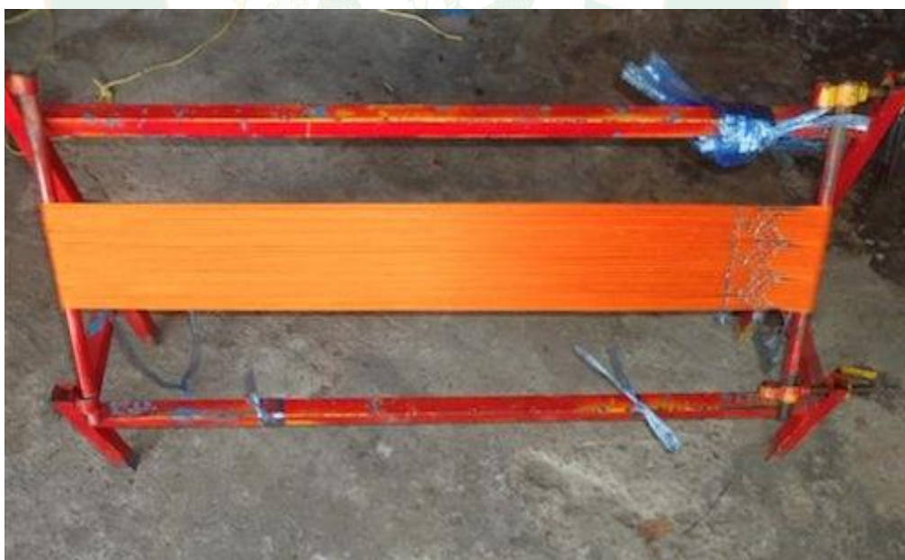
ภาพผนวกที่ 25 โองคันทมิ ใช้สำหรับจัดเส้นไหมเพื่อนำไปมัดหมี่
