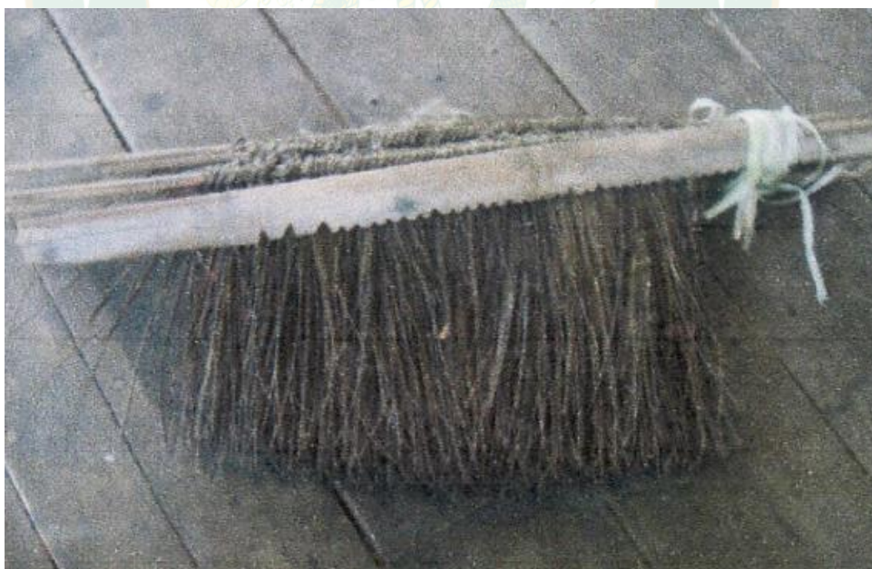
ภาพผนวกที่ 34 แปรง หรือแปรงเซ็ดเมาะ สำหรับหวีไหมเส้นยืน
