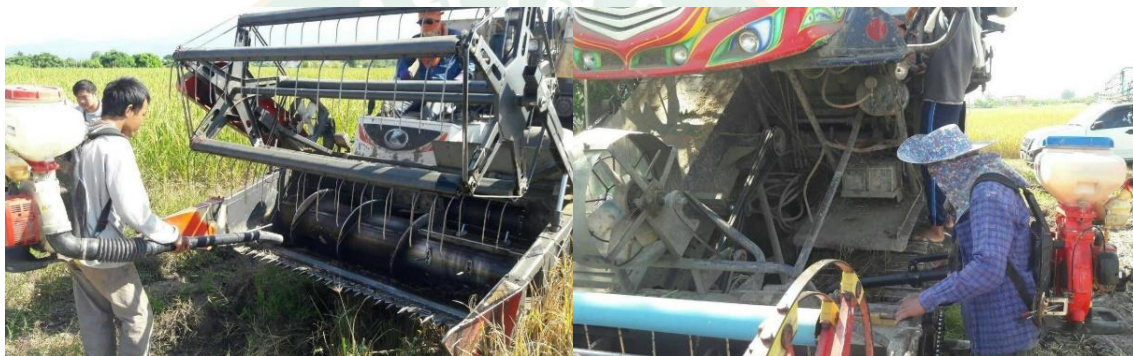
ภาพที่ 8 การทำความสะอาดเครื่องเกี่ยวขนาดก่อนทำการเก็บเกี่ยวข้าวทุกครั้ง
