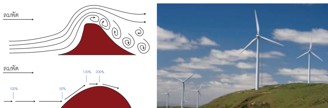
ภาพที่ 17 ผลกระทบของเนินเขา (บน) และความเร็วลมเปลี่ยนแปลง จากผลกระทบของเนินเขา (ล่าง)
