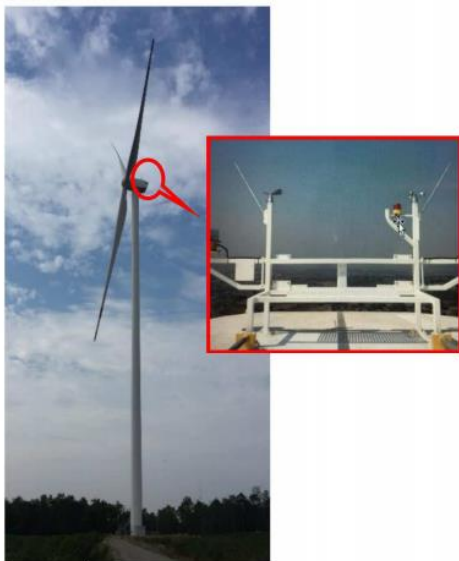
รูปที่ 5 อุปกรณ์วัดลมบน Nacelle ของกังหันลม
