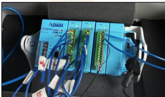
รูปที่ 55 อุปกรณ์บันทึกข้อมูลอัตโนมัติ (Data Logger ADAM-5000/TCP)
