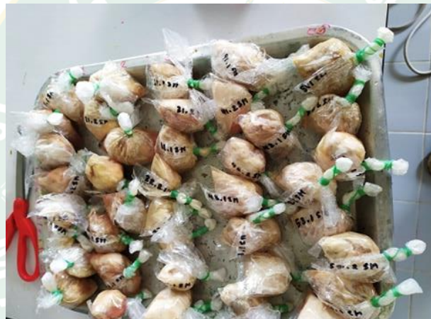
การเตรียมเนื้อเพื่อวัดค่าการสูญเสียน้ำจากการต้ม
