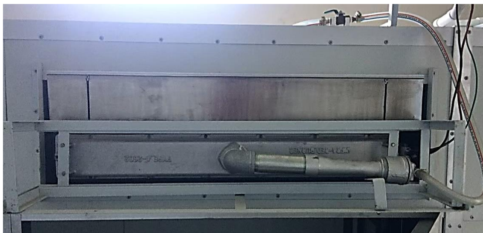
ภาพที่ 15 หัวพ่นอินฟราเรดชนิดใช้ก๊าซเป็นเชื้อเพลิงที่ใช้ในวิสาหกิจชุมชนแปรรูปผลิตภัณฑ์เกษตร
