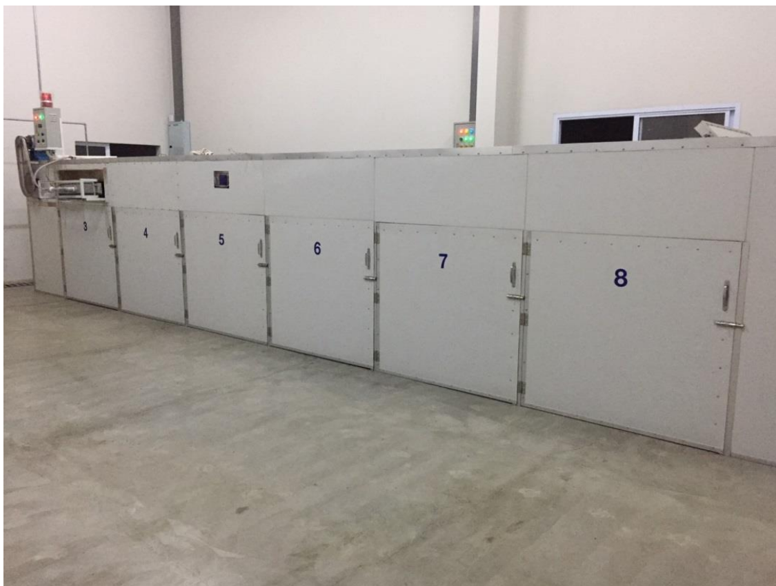
ภาพที่ 8 เครื่องอบแห้งแบบต่อเนื่องชนิดอุโมงค์ด้วยก๊าซอินฟราเรด-ลมร้อนของกลุ่มวิสาหกิจ หมายเลขตู้ 3 ถึง 8
