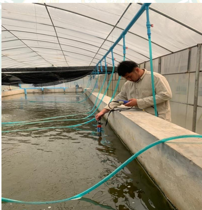
ภาคผนวกที่ 11 วัดปริมาณออกซิเจนละลายในน้ำ ทุก 1 ชั่วโมง เป็นเวลา 24 ชั่วโมง
