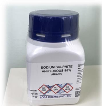
ภาคผนวกที่ 4 สาร Sodium sulphite ( \text{Na}_2\text{SO}_3 ) ใช้ลดปริมาณออกซิเจนในน้ำ
