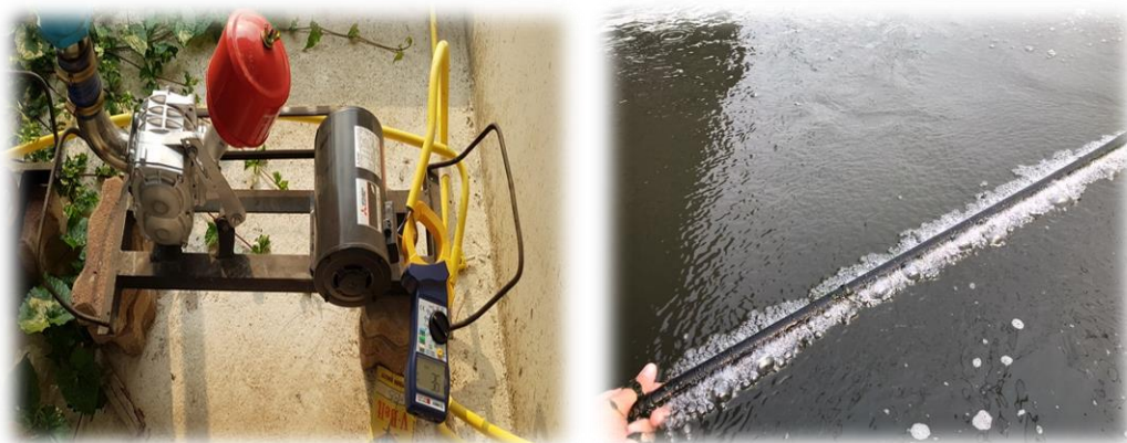
ภาพที่ 16 เครื่องเติมอากาศแบบท่ออย่างยืดหยุ่น (400 วัตต์)
