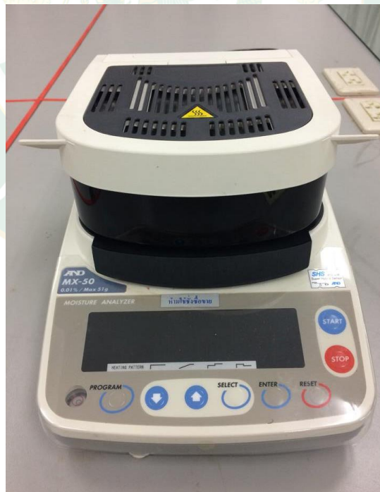
ภาพผนวกที่ 7 เครื่อง Infrared moisture determination balance
