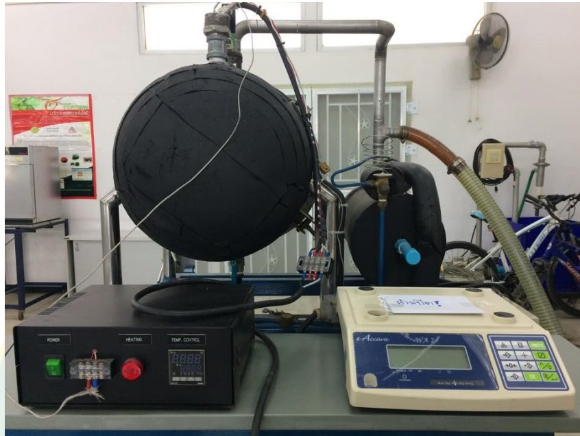
ภาพผนวกที่ 1 ชุดทดสอบการอบแห้งแบบสุญญากาศร่วมกับอินฟราเรด
