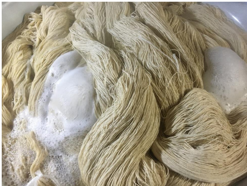
ภาพที่ 21 การเตรียมเส้นฝ้ายโดยการต้มที่อุณหภูมิ 100 องศาเซลเซียส
