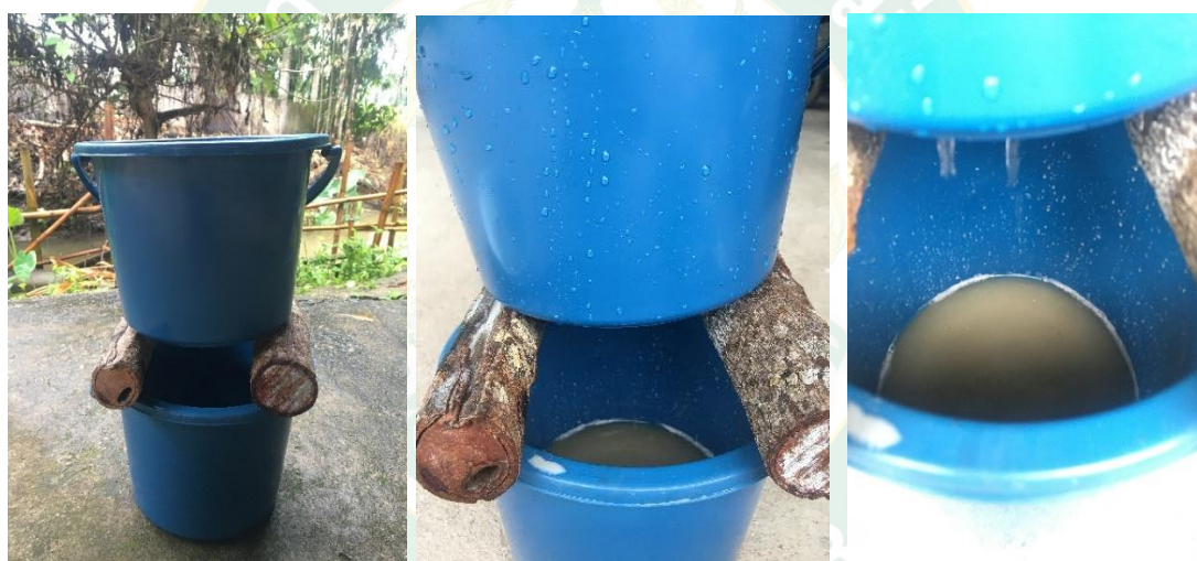
ภาพที่ 18 การกรองน้ำซีเมนต์จากเหง้ากล้วยป่า (น้ำต่าง)
