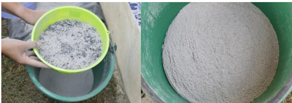
ภาพที่ 17 การกรองโดยใช้ตะแกรงร่อนเพื่อเอาเศษไม้ เศษถ่านและสิ่งเจือปนอื่น ๆ ออกเหลือเนื้อซีเมนต์ที่มีความละเอียด
