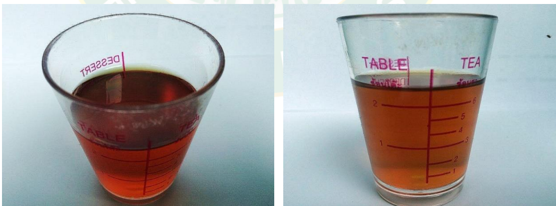
ภาพที่ 4.1 น้ำมันเหลือใช้จากอุตสาหกรรมแปรรูปมะพร้าว (Waste oil) หรือน้ำมันดำ
