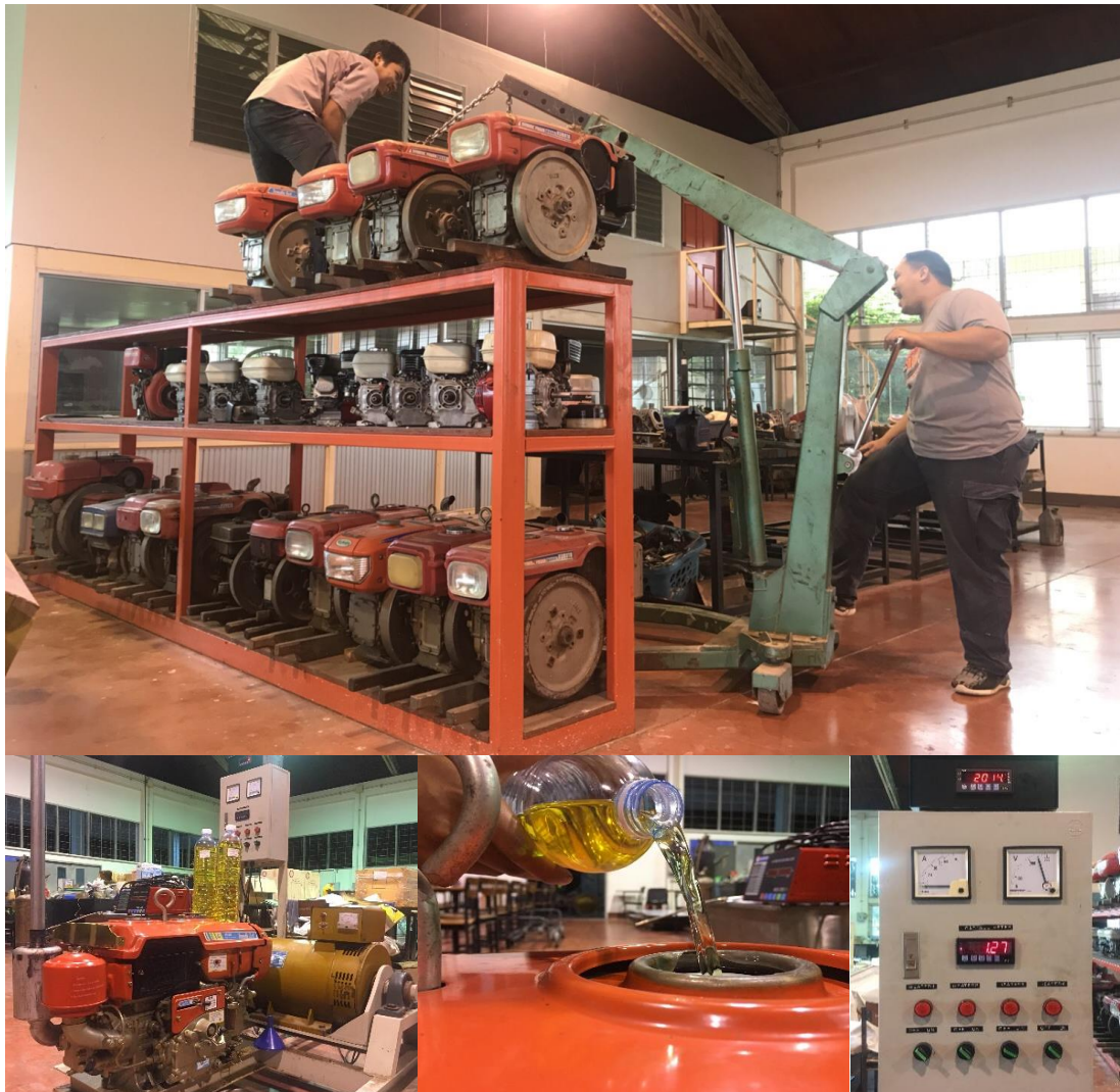
ภาพที่ 4.7 ทดสอบสมรรถนะกับเครื่องยนต์ดีเซลสูบเดี่ยว (รอบต่ำ) ยี่ห้อ คูโบต้า ขนาด 9.5 แรงม้า
