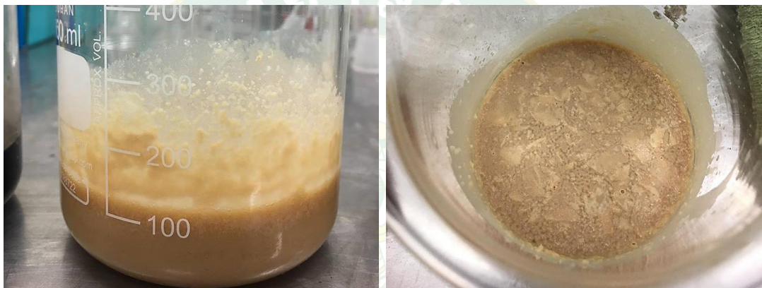
ภาพที่ 4.2 ผลการทดลองในกระบวนการทรานส์เอสเทอริฟิเคชันของน้ำมันเหลือใช้โดยใช้เมทานอลเป็นตัวทำละลายใช้โซเดียมไฮดรอกไซด์เป็นตัวเร่งปฏิกิริยา
