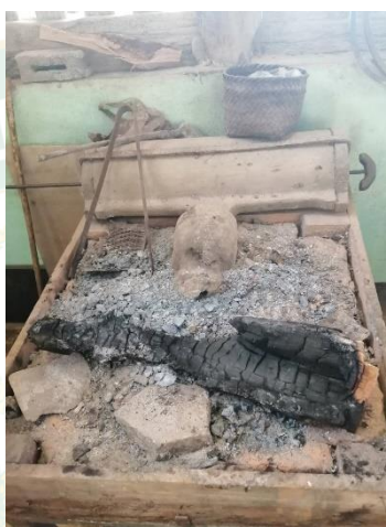
ภาพที่ 14 โรซอตัว (กำเนิดลมในการเผาเหล็กหรือหลอมเงิน)
