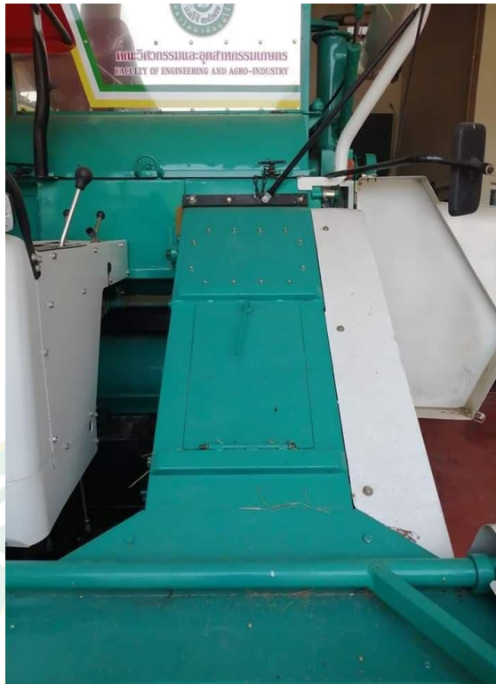
ภาพที่ 19 ชุดป้อนลำเลียงเข้าสู่ระบบนวด
