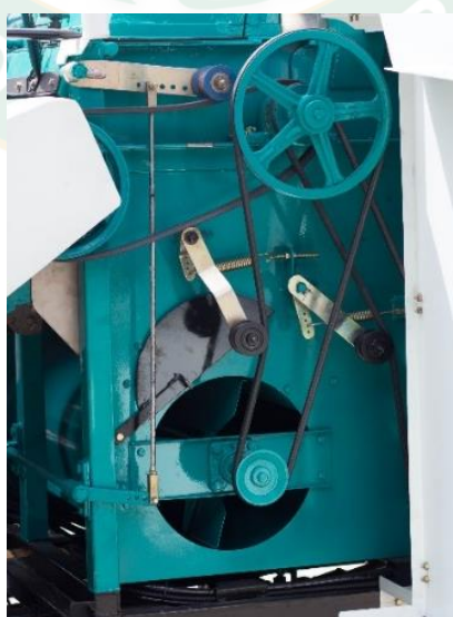
ภาพที่ 16 พัดลมเป่าละอองฟ่อนผง และเมล็ดลีบ
