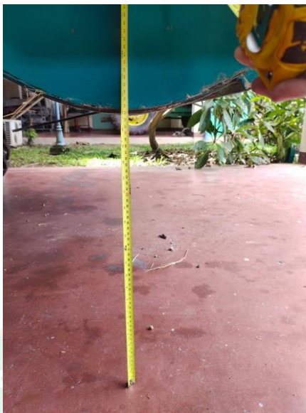
ภาพที่ 29 วัดความสูงใบมีดขณะใบมีดอยู่ในตำแหน่งสูงสุด
