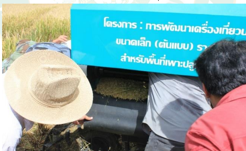
ภาพที่ 61 เข้าไปดึงเศษฟางที่อุดตันออกมาจากตะแกรงร้อน
