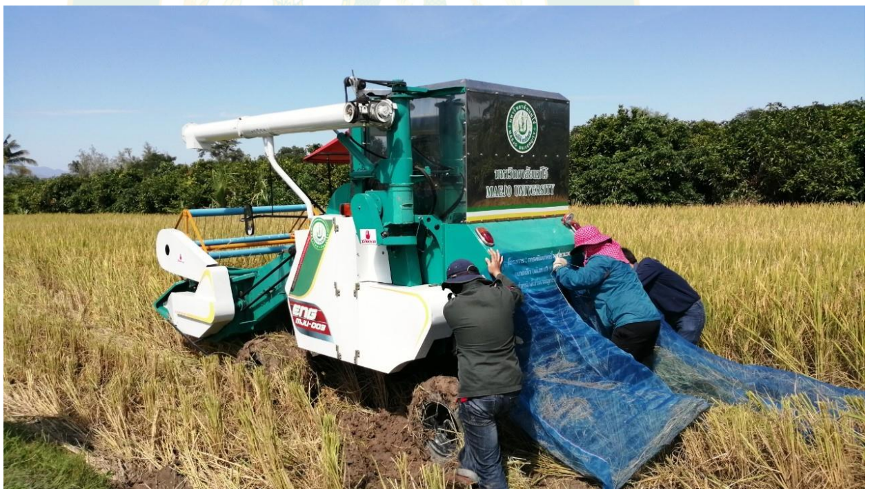
ภาพที่ 40 ใช้ตาข่ายรองรับวัสดุที่ถูกขับออกมาจากช่องขับฟางและตะแกรงด้านท้ายเครื่องเกี่ยวนวด
