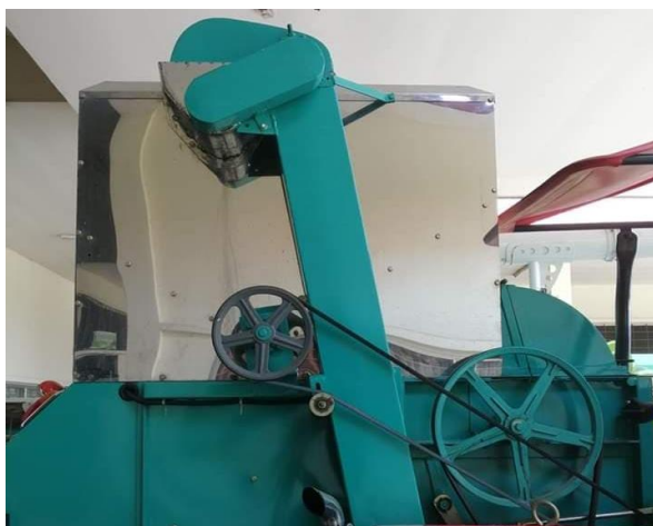
ภาพที่ 21 ท่อลำเลียงเข้าสู่ถังเก็บบรรจุข้าวเต็มเมล็ด
