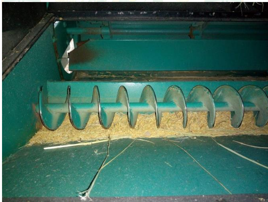
ภาพที่ 20 ใบเกลี่ยวลำเลียงข้าวเต็มเมล็ดภายในระบบทำความสะอาด
