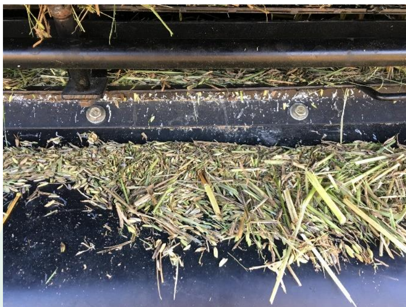
ภาพที่ 60 ตะแกรงร้อนอุดตัน
