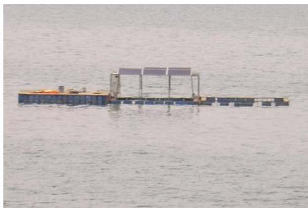
ภาพที่ 20 ระบบการเติมอากาศอัตโนมัติสำหรับบ่อเพาะเลี้ยงปลา ที่มา: (Bayrak & Lebeli, 2011)
